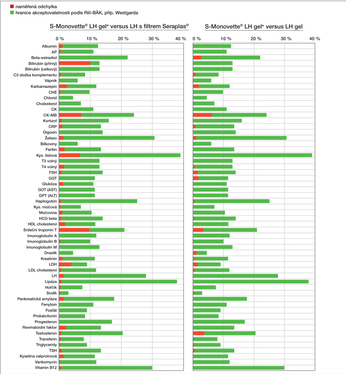
Obrázek 4 Porovnání zkumavky S-Monovette® lithium heparin s filtrem Seraplas® / lithium heparin gel se zkumavkou S-Monovette® lithium heparin gel + . Znázorněn je kladný medián odchylky mezi odběrovými krevními zkumavkami. Všechny odběrové krevní zkumavky byly podrobeny centrifugaci při 3000 g po dobu 10 minut. Měření probíhalo na modulu Roche cobas c 702 nebo na modulu e 602. RF a C3 se měřilo na zařízení Siemens BN Prospec.
